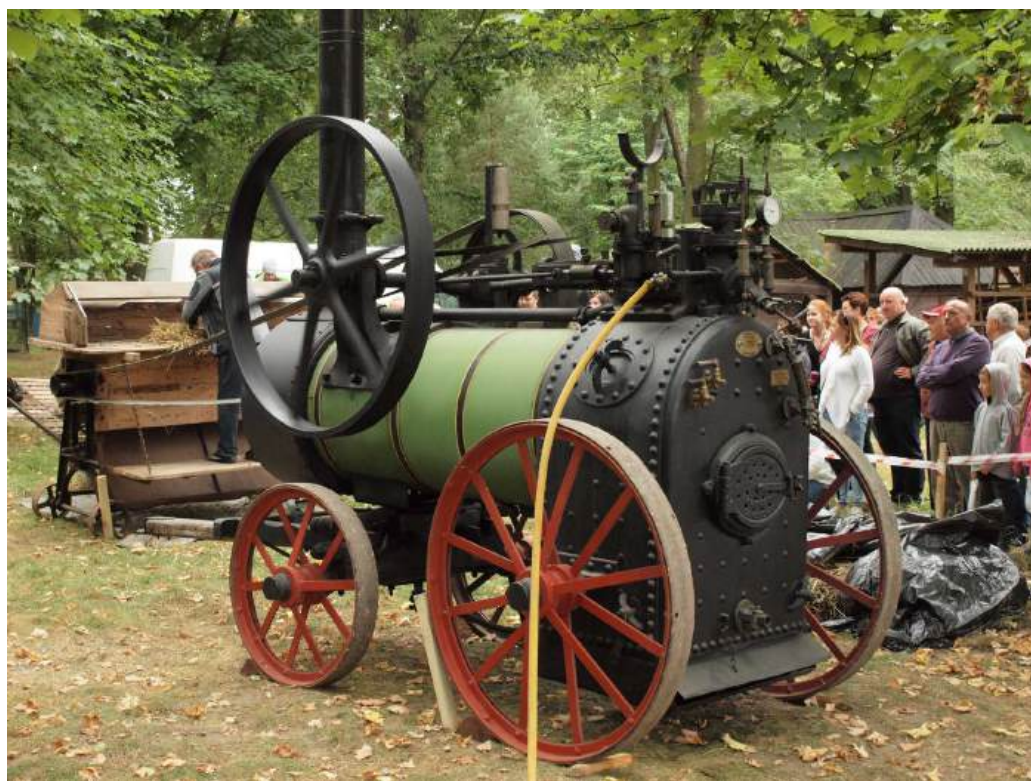
Il. 2. Pokaz pracy młocarni napędzanej lokomobilą angielską firmy Robey and Co. podczas imprezy „Jesień w domu i zagrodzie. Retro Show” w Muzeum w Szreniawie, 2016, z archiwum MNRI PR-S w Szreniawie
