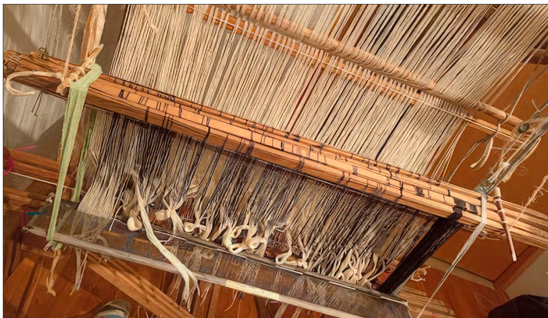
II. 4. Proces przekładania osnowy przez nicielnice. Fot. E. Kępa (2023).
