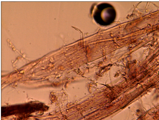
Fot. 3. Włókna papieru z widocznymi drobkami kleju żywicznego oraz drobnej frakcji włókien (tzw. krylu) po wybarwieniu roztworem nadmanganianu potasu, wygotowaniu w wodzie i wybarwieniu odczynnikiem Herzberga (mikroskop biologiczny, światło przechodzące, powiększenie 400x; fot. T. Kozielec)
