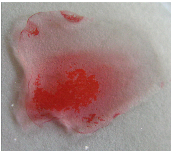
Fot. 4. Czerwony lak glinowy, powstały w reakcji siarczanu glinu z aluminonem (makrofotografia; fot. T. Kozielec)
