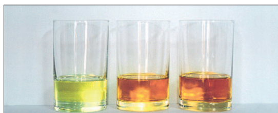
Fot. 6. Roztwory Paraloidu B-72 po impregnacji przez zanurzenie na 24 godziny kostek sosnowych. Od lewej: w toluenie, eterze metylowym glikolu dipropylenowego i 1-metoksy-2-propanolu (fot. K. Szczepińska)
