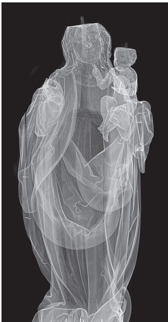
Il. 3. Kraków, klasztor Ojców Dominikanów. Rzeźba Madonny z Dzieciątkiem, pocz. XVI w. Rentgenogram przed konserwacją. Widoczne gwoździe w strukturze drewna, pionowy układ słojów, lokalnie korytarze po drewnojadach oraz zarys wstawki, szczelnie przykrytej narzutem grubej zaprawy i złoceńiami. Fot. M. Obarzanowski, T. Wilkosz
