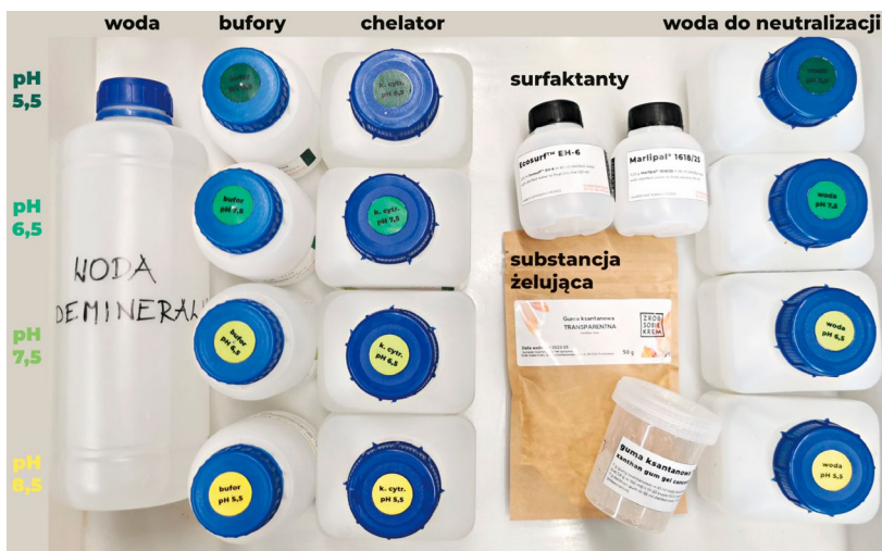
II. 2. Przykład podstawowego zestawu wodnych roztworów wyjściowych przygotowanych według programu Modular Cleaning Program: woda demineralizowana, cztery roztwory różnych buforów – inny dla każdej wartości pH, cztery roztwory kwasu cytrynowego i NaOH, dwa roztwory surfaktantów (Ecosurf EH-6 i Marlipal 1618/25), guma ksantanowa jako przykład substancji żelującej oraz cztery roztwory modyfikowanej wody. 2024. Fot. P. Węgrzyn-Jankowiak
