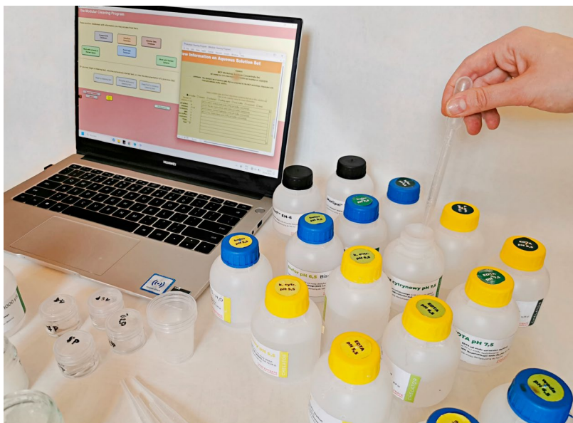
II. 1. Rozpoczęcie pracy metodą Modular Cleaning Program – przygotowanie żeli na bazie sporządzonych wcześniej roztworów wyjściowych za pomocą programu komputerowego. 2024. Fot. P. Węgrzyn-Jankowiak
